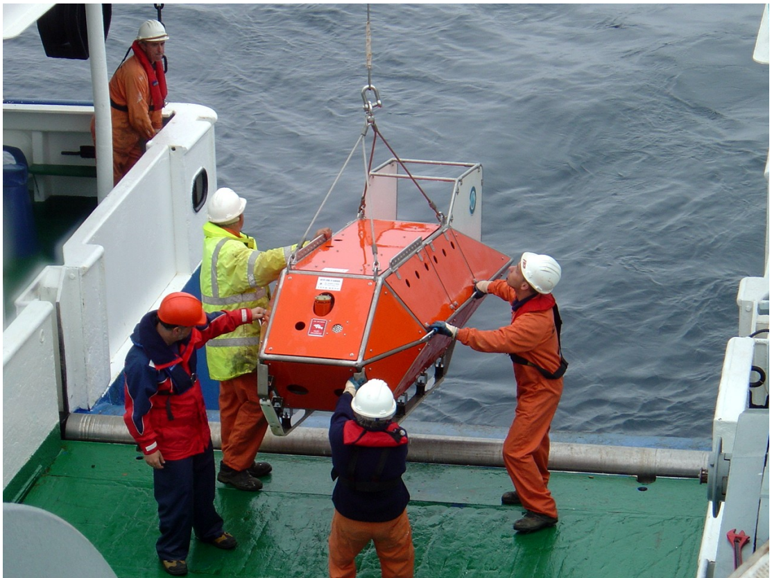
Largando el trineo de fotogrametría desde el B/O Vizconde de Eza .
