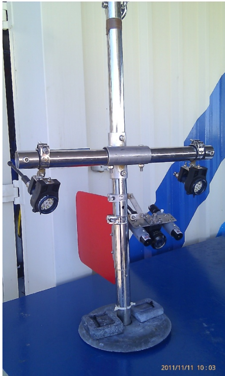
Figura 10: Sistema CCTV de cámara submarina para la realización de vídeos remolcados desde pequeñas embarcaciones.
