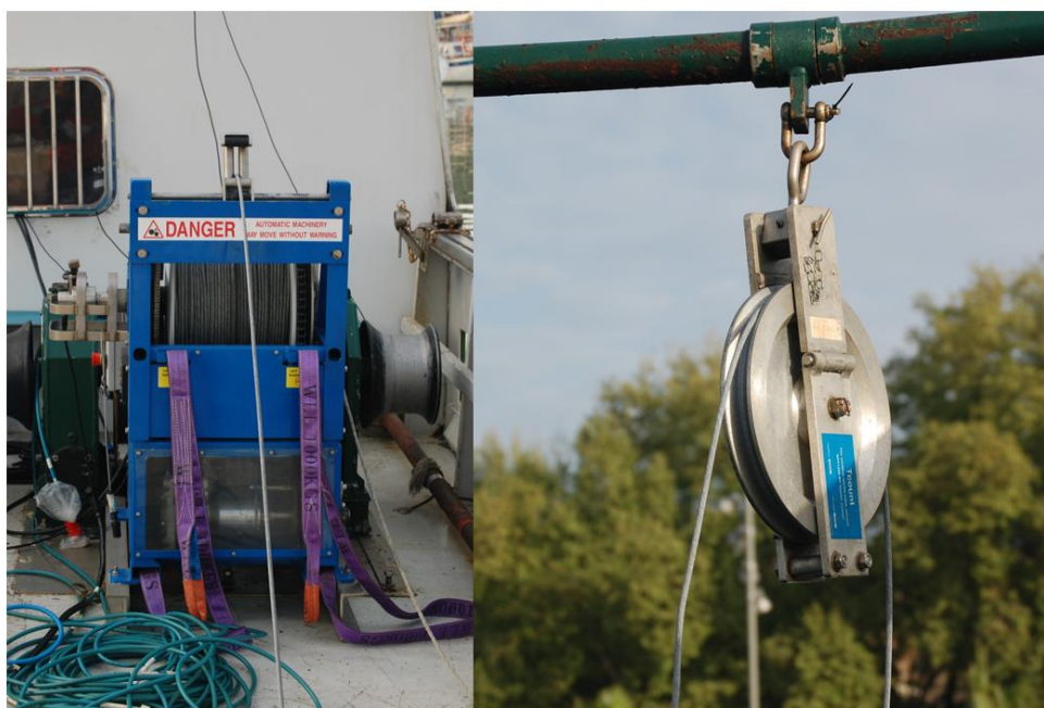
Figura 21. Winche eléctrico CSW-7 y pasteca cuentavueltas digital.
