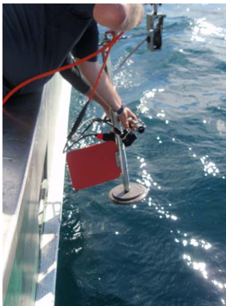
Figura 65. Cámara de vídeo utilizada para la inspección subacuática.
