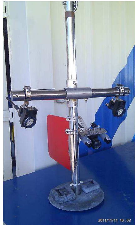
Figura 3.2.2. Sistema CCTV de cámara submarina para la realización de vídeos remolcados desde pequeñas embarcaciones.
