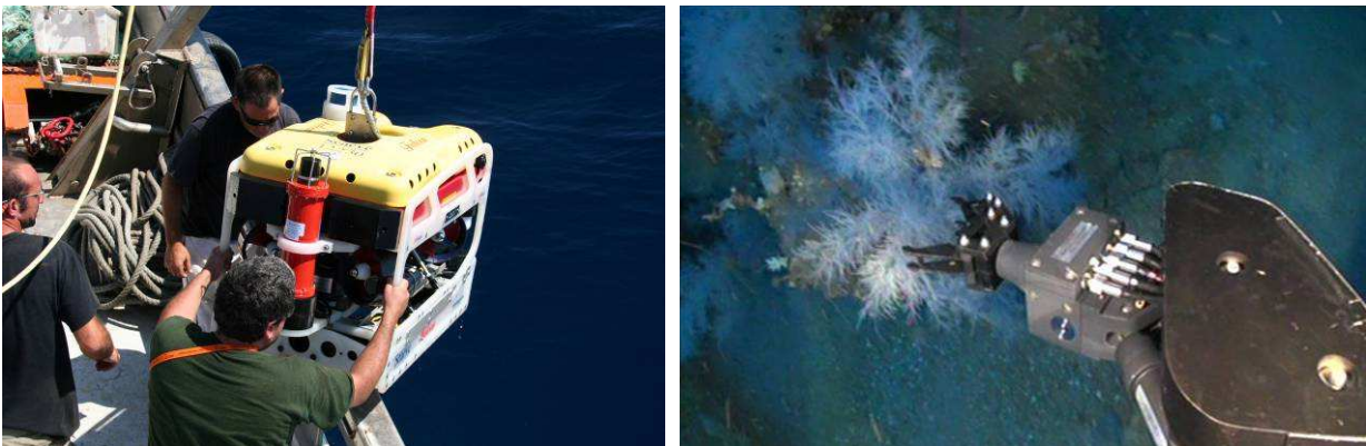
Figura 3.3.1. El ROV y su brazo articulado recogiendo un fragmento de un antipatario (transecto ROV15).
