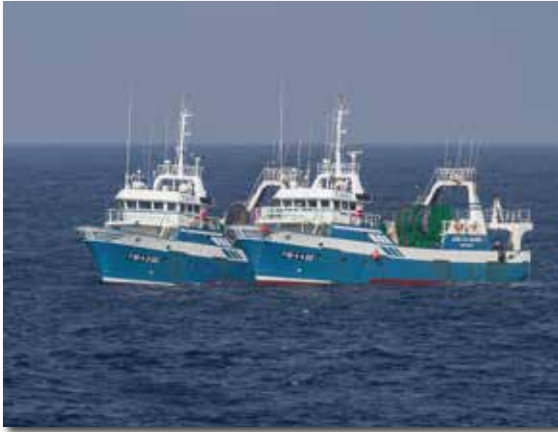
Figura 7.2. Barcos de arrastre a la pareja, pasándose la malleta para que uno de ellos vire el aparejo. Foto: IEO – A. Punzón.
