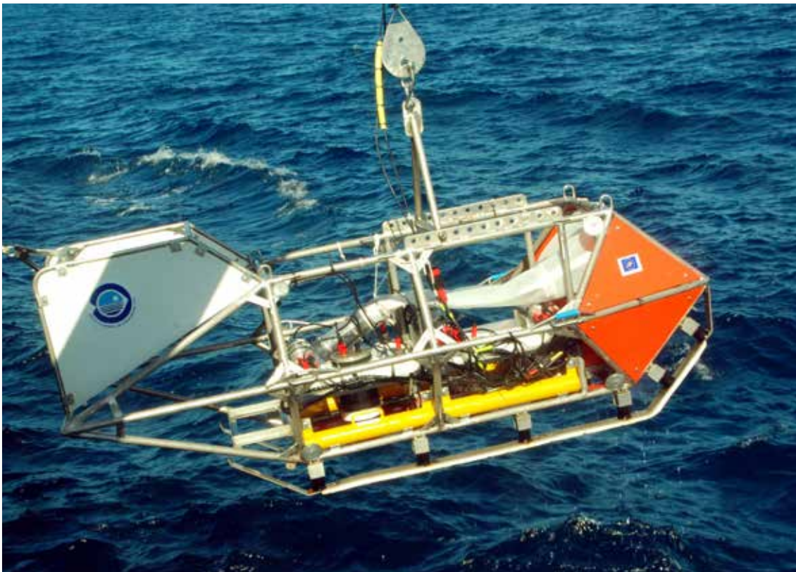
Figura 3.4. Trineo fotogramétrico utilizado en el estudio no invasivo de los hábitats profundos (Cuadro 3). Fuente: IEO - F. Sanchez.
