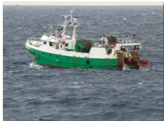
Figura 7.1. Barco de arrastre, en el momento de largar las puertas de arrastre. Foto: IEO – A. Punzón.
