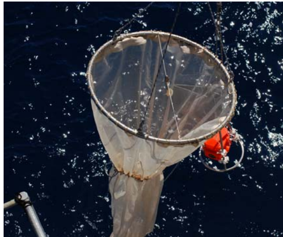
Foto 4.6.1. Red de plancton WP2 utilizada para el muestreo de las comunidades bentopelágicas
