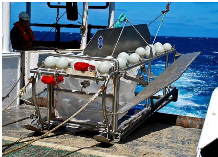
Foto 4.5.1. Trineo suprabentónico utilizado en la campaña INDEMARES BANGAL0711. (Valeiras).
