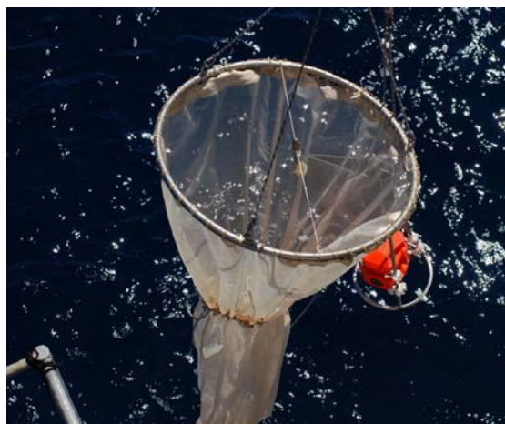
Foto 4.6.1. Red de plancton WP2 utilizada para el muestreo de las comunidades bentopelágicas
