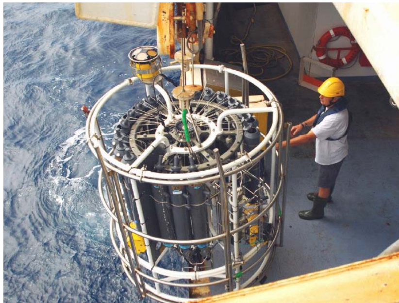
Foto 4.8.1. Recuperando la roseta desde el pórtico de hidrografía del B/O Thalassa .
