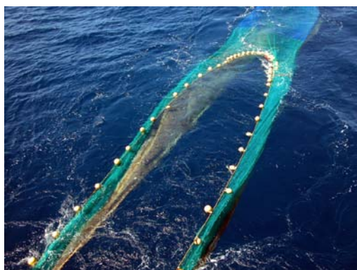
Foto 4.3.1. Arrastre tipo GOC-73 utilizado para el muestreo del dominio demersal y megaepibentónico
