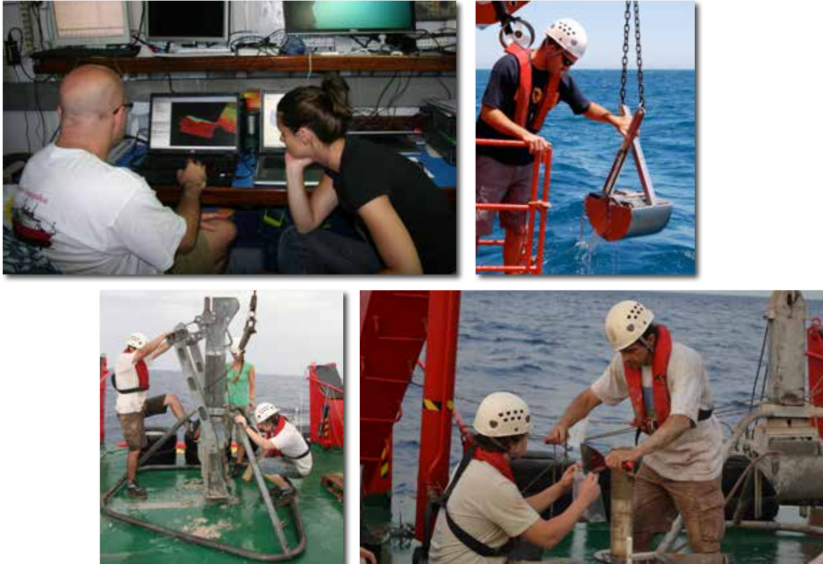
Figura 3.2. (de izda. a dcha. y de arriba abajo): Investigadores del ICM/CSIC procesando los datos obtenidos mediante la sonda multihaz a bordo del B/O “García del Cid”. (Foto: ICM / CSIC - Josep - María Gili); draga “Van Veen” utilizada para los análisis de granulometría (Foto: IFM/GEOMAR - Karen Hissman); draga “Box-corer” utilizada para la recolección de testigos de sedimento. (Foto: ICM/CSIC - Josep-Maria Gili) y procesado “in-situ” de las muestras de sedimento recogidas con la Box-corer (Foto: ICM/CSIC - Alejandro Olariaga).
