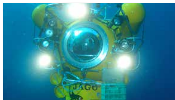
Figura 3.5. Imágenes del sumergible “JAGO”, que permite realizar inmersiones hasta los 400 metros de profundidad y con capacidad para dos personas. Foto: IFM/GEOMAR - Karen Hissman y Toni García.
