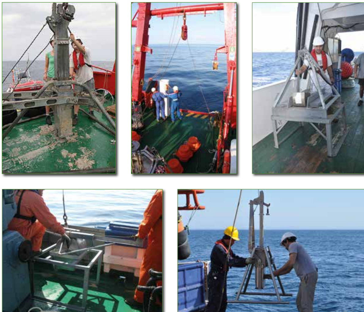
Figura 3.1. Sistemas de toma de muestras sedimentarias mediante dragas y maniobra del fondeo de una trampa de sedimento para obtener datos de tasas de sedimentación. (Superior izquierda) Saca-testigos; (Superior centro) fondeo trampa sedimentos; (Superior derecha) draga Hammonn; (Inferior izquierda) draga Van Veen; (Inferior derecha) draga Box-Corer. Fuente: (Superior izquierda y centro) CSIC; (Superior derecha) COB-INDEMARES; (Inferior izquierda) COB-EQUIPAR; (Inferior derecha) COB-CANAL.
