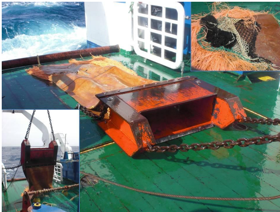
Figura 7. Draga de roca en cubierta y detalles de sus partes y las maniobras con ella.
