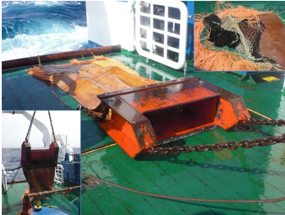
Figura 4.5.1. Draga de roca en cubierta y detalles de sus partes y las maniobras con ella.
