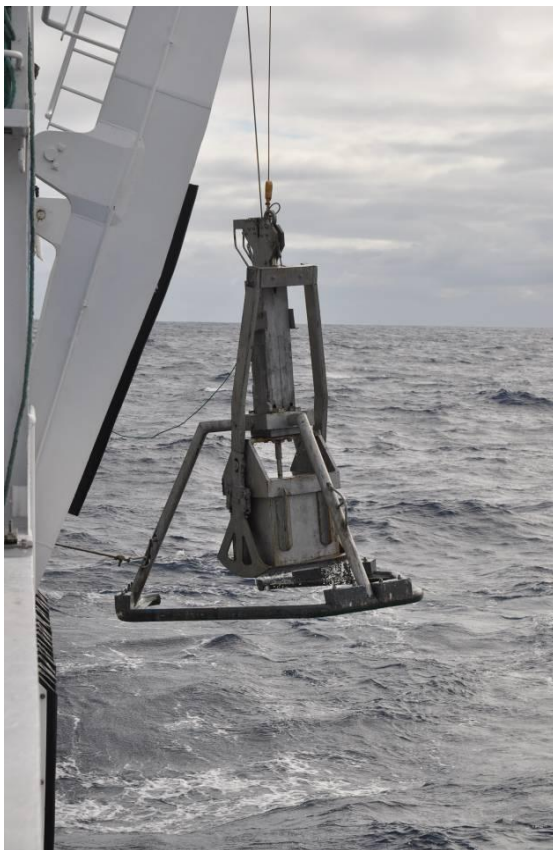
Figura 4.6.1. Draga Mega Box Corer: maniobra de virado y muestras resultantes.
