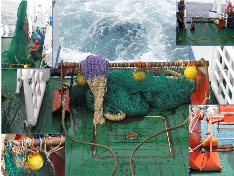
Figura 6. Bou de vara en cubierta y detalles de sus partes y las maniobras con él.
