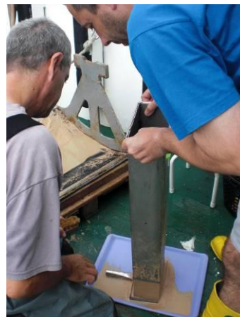
Figura 4.6.1. Draga Mega Box Corer: maniobra de virado y muestras resultantes.
