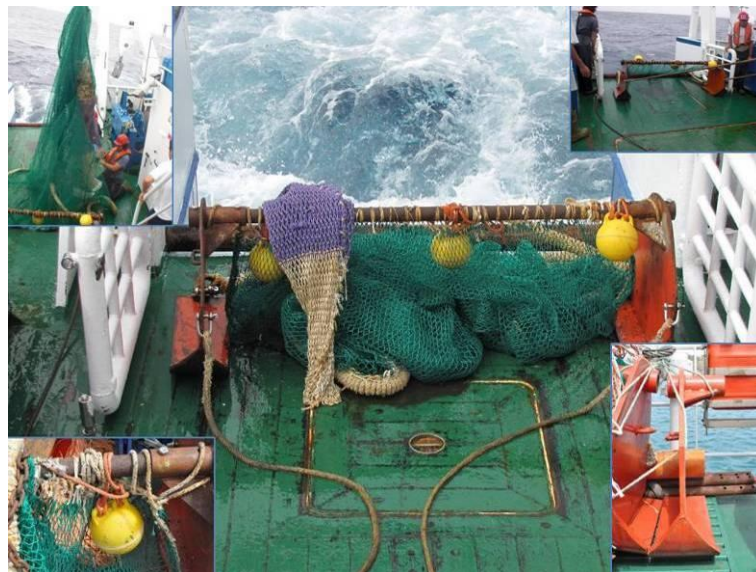
Figura 4.4.1. Bou de vara en cubierta y detalles de sus partes y las maniobras con él.
