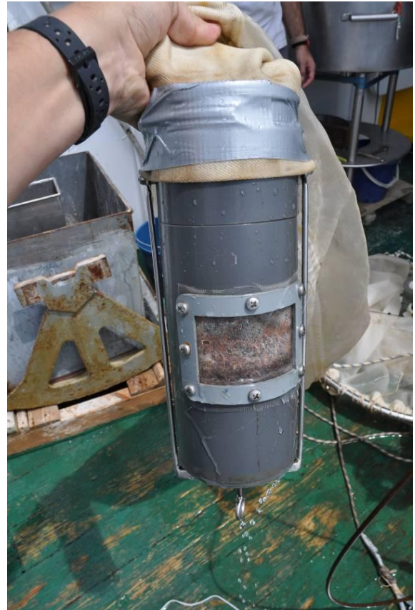
Figura 4.7.1. Red de plancton WP2: maniobra y detalles de accesorios.
