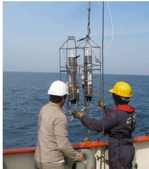
Figura 4.2.1.- Sondas multiparamétricas (CTD) utilizadas durante la campaña CANAL0209 (arriba) y INDEMARES_CANAL0811 (izquierda).
