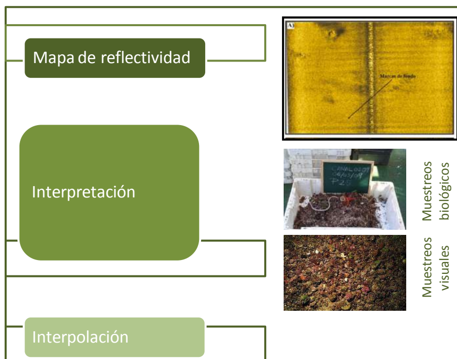
Figura 4.9.1.- Esquema de las diferentes fases en el proceso de identificación y clasificación de hábitats. El cartografiado se basó en prospección mediante técnicas acústicas (Multihaz y Sonar de Barrido Lateral), muestreos biológicos (patín epibentónico) y observaciones directas con ROV y cámara submarina.
