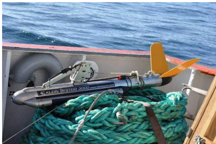
Figura 4.3.13.- Pez hidrodinámico (sensor) del sonar de barrido lateral modelo Klein 3000.
