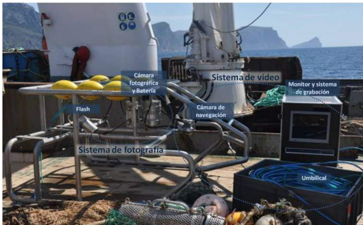
Figura 4.8.8.- Trineo de fotografía y vídeo utilizado en la campaña. Se señalan los dos sistemas independientes de captación de imágenes (fotografía y vídeo).
