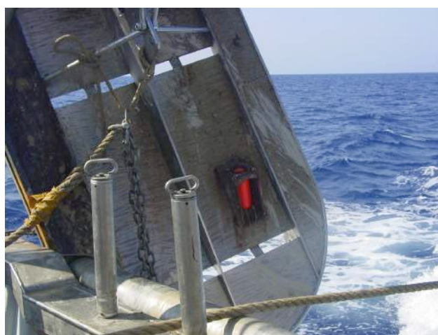
Fotografía 8.5.- Puerta utilizada por una embarcación de pesca de arrastre.
