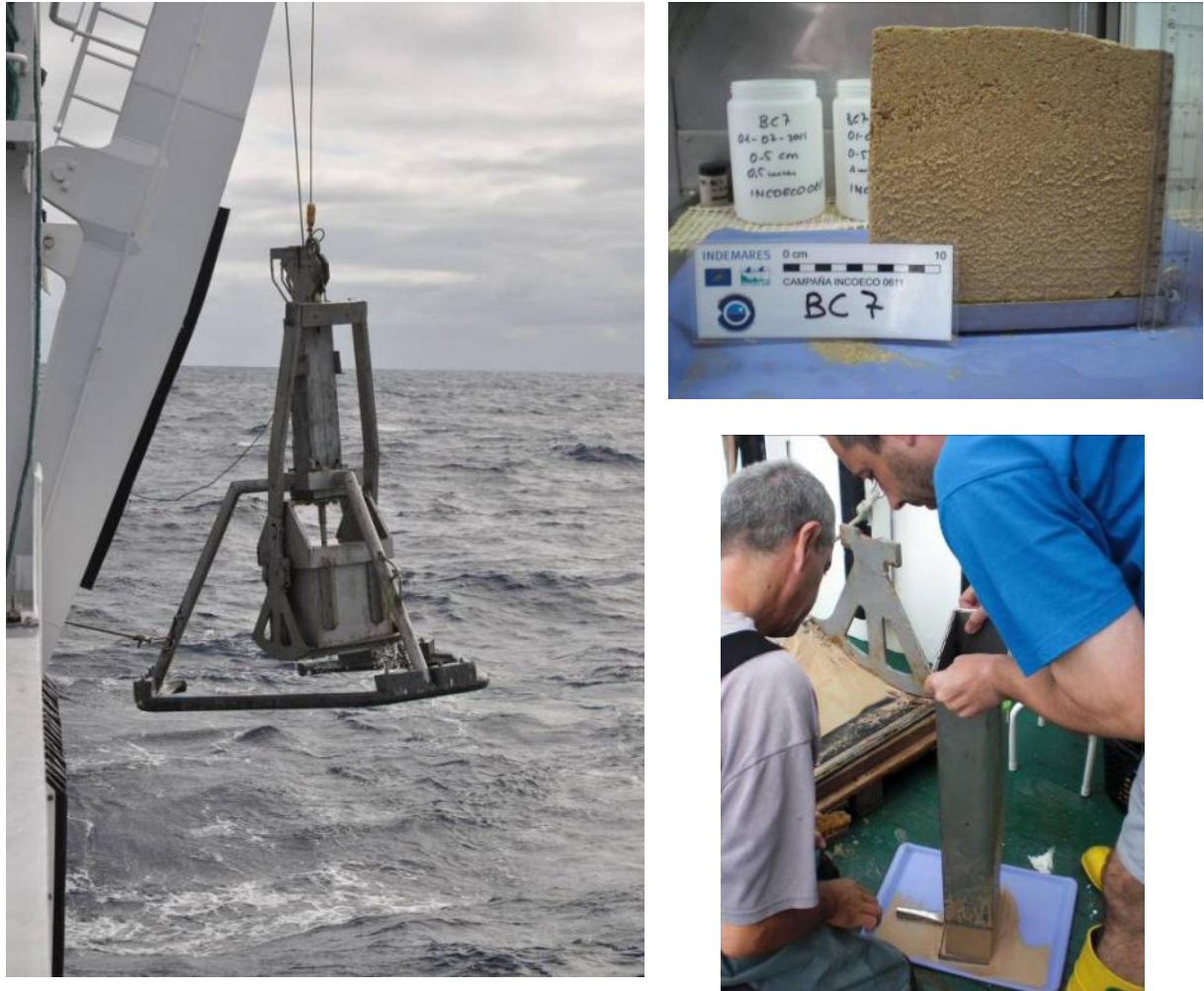
Figura 4.4.2. Draga Mega Box Corer: maniobra de virado y muestras resultantes.
