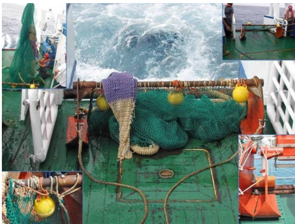
Figura 4.4.5. Bou de vara en cubierta y detalles de sus partes y las maniobras con él.
