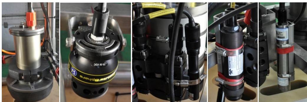
Figura 4.4.17. De izquierda a derecha, flash submarino, leds, lasers, altímetro y sensor de presión.
