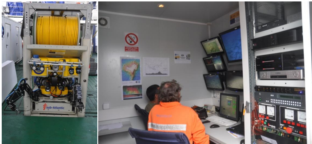
Figura 4.4.12. ROV metido en el TMS e interior del puesto de control
