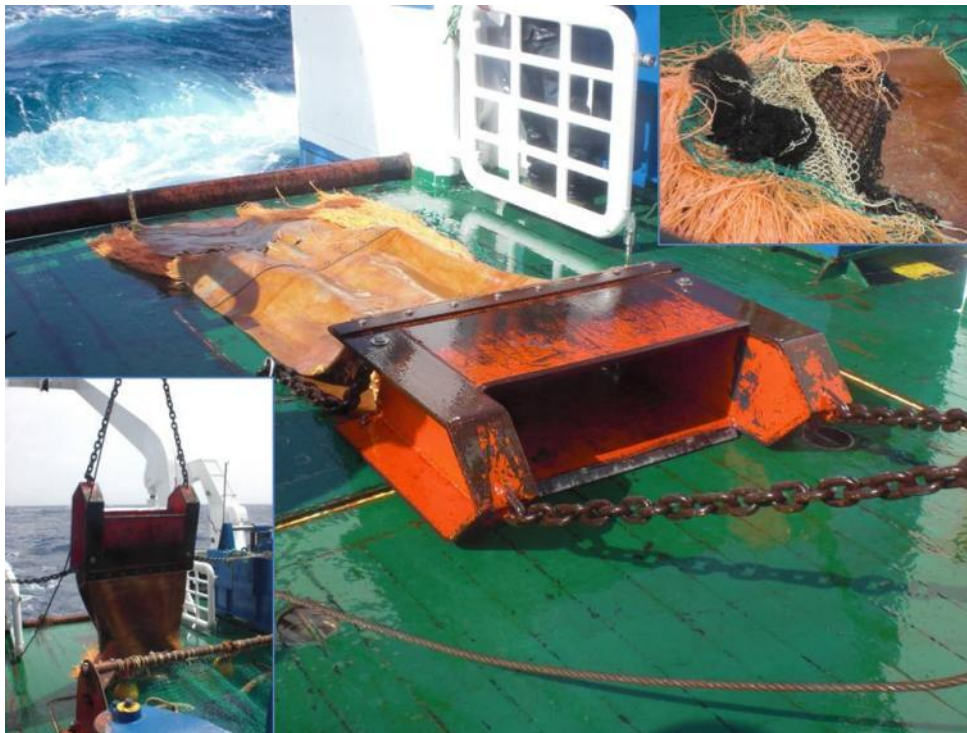
Figura 4.4.6. Draga de roca en cubierta y detalles de sus partes y las maniobras con ella.
