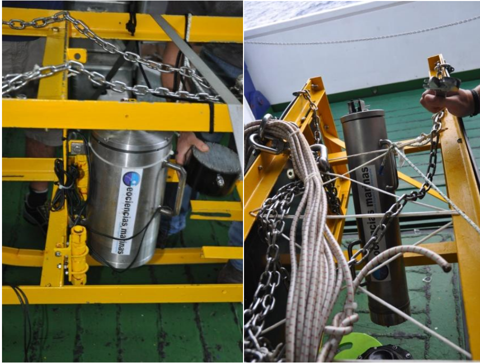
Figura 4.4.14. Detalles de la cámara de fotos (izquierda) y de vídeo (derecha), introducidas en sendas carcassas estancas de resistencia a alta presión.
