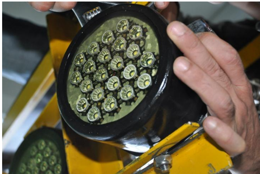
Figura 4.4.15. Detalle de los focos de leds.
