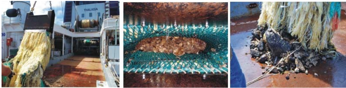
Foto 5.- Draga de roca izada en la cubierta a bordo del B/O Thalassa e imágenes de muestras obtenida antes y después de depositarse en la cubierta del barco
