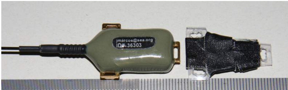
Figura 2. Emisores vía satélite (PTT) de 5 gr destinados al marcaje de la pardela chica, y placa de metacrilato con la cinta TESA puesta en la manera de la colocación del ave. Foto: B. Rodríguez.
