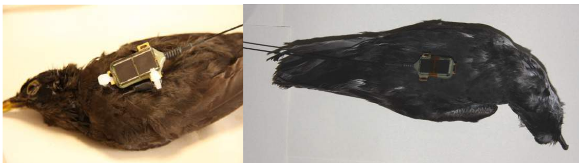
Figura 3. Pruebas de sujeción del PTT de 5 gr sobre un mirlo común y sobre pardela chica. Foto: B. Rodríguez.
