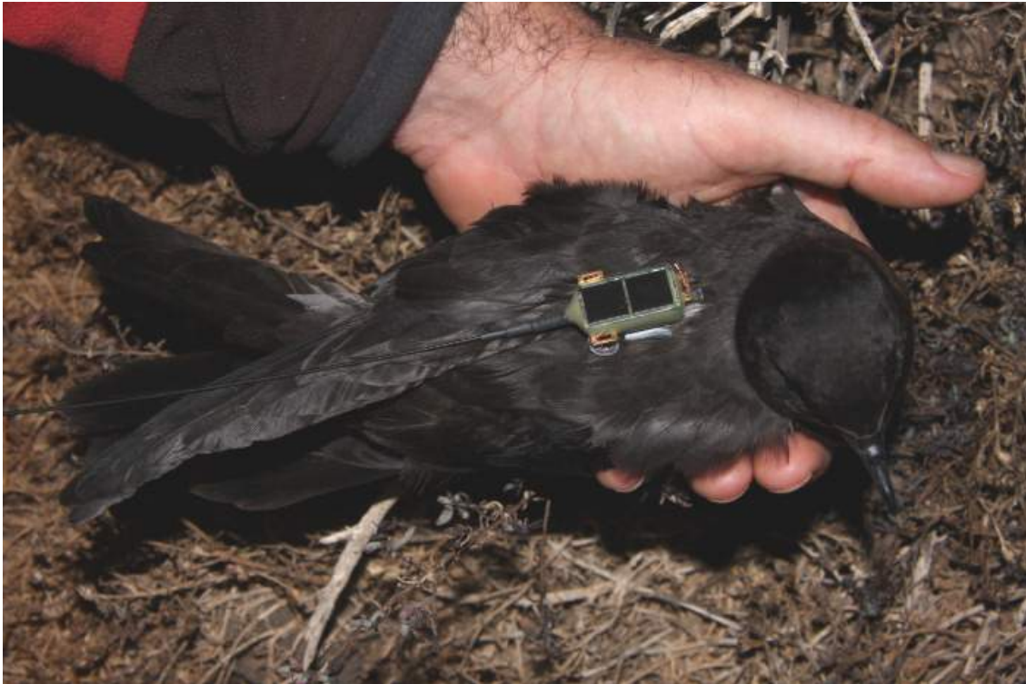
Figura 3. Petrel de Bulwer Bulweria bulwerii equipado con un emisor satélite (PTT) de 5 g, en el que se aprecia como el emisor va sujeto a la placa de metacrilato con alambre de cobre, y esta a su vez con la cinta TESA a las plumas del dorso del ave. Foto: B. Rodríguez.
