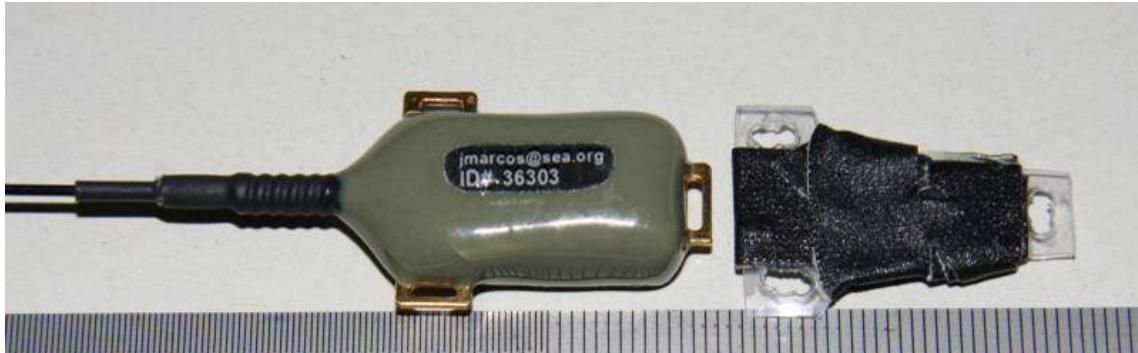
Figura 2. Emisores satélite (PTT) de 5 g y placa de metacrilato, con la cinta TESA puesta en la manera de la colocación del ave, originariamente destinados a la pardela chica y que fueron aprovechados para el petrel de Bulwer Bulweria bulwerii . Foto: B. Rodríguez.
