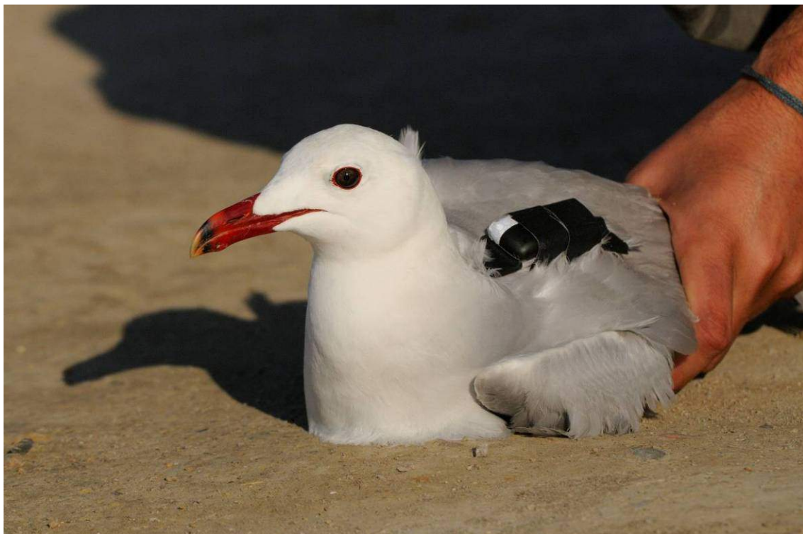
Figura 3. Gaviota de Audouin equipada con el registrador GPS. Se puede observar la cinta reflectante para recuperar con mayor facilidad en caso de caída del GPS en el nido. Foto: Juan Bécares.
