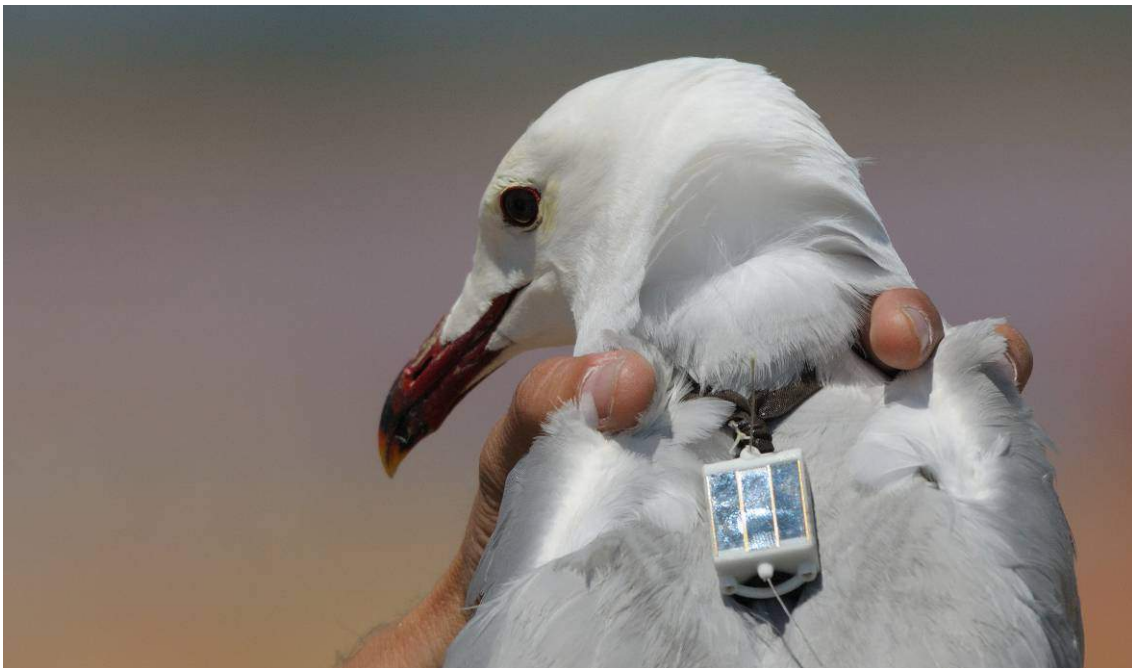
Figura 4. Ejemplar de Gaviota de Audouin con el dispositivo GPS solar de descarga a distancia colocado mediante arnés torácico. Foto: Juan Bécares.
