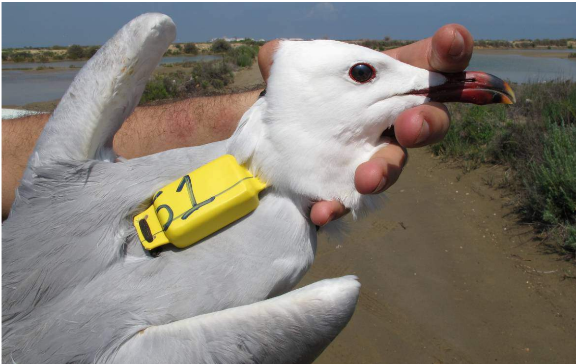
Figura 4. Ejemplar de Gaviota de Audouin con el dispositivo GPS colocado mediante arnés torácico. se observan los agujeros realizados para la unión del arnés a la manga termoretractil. Foto: Juan Bécares.
