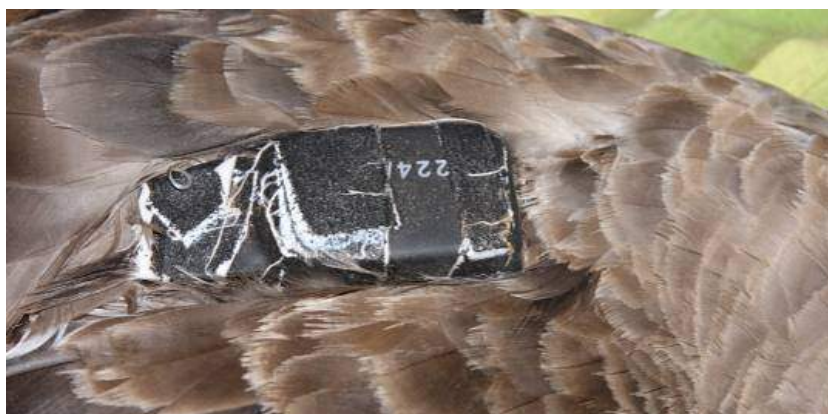
Figura 3. Registradores GPS para seguimiento de mascotas Cat@track recubierto con goma termo-retráctil, colocado en pardela cenicienta justo antes del momento de ser retirado tras un viaje de alimentación en el mar. Foto: B. Rodríguez.
