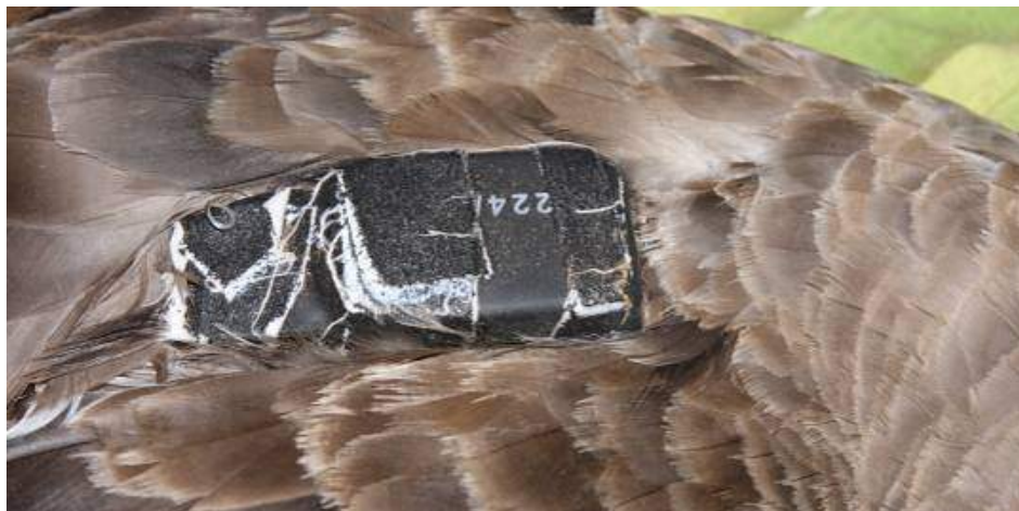
Figura 3. Registradores GPS para seguimiento de mascotas Cat@track recubierto con goma termoretráctil, colocado en pardela cenicienta justo antes del momento de ser retirado tras un viaje de alimentación en el mar.
